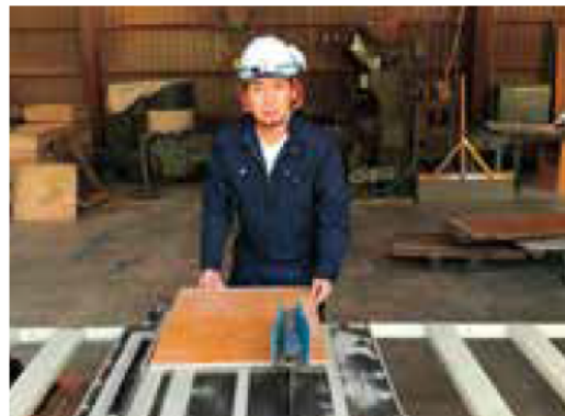
転用材を裁断してパネルを製作
